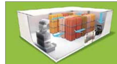
庫内湿度を常に90%以上の飽和に近い空気状態を保ち、青果物への結露を防ぎながら蒸散を防ぐ仕組みである。
