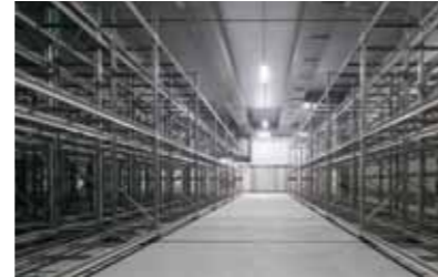
移動ラックはカーゴナビゲーションシステムとセットで導入されている。
