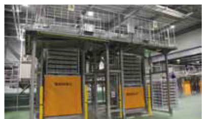
脱パンは、最もキツイ作業だったが、ほとんど人手を介さず行える自動脱パンラインを唐津、佐世保、枕崎に続いて導入。
